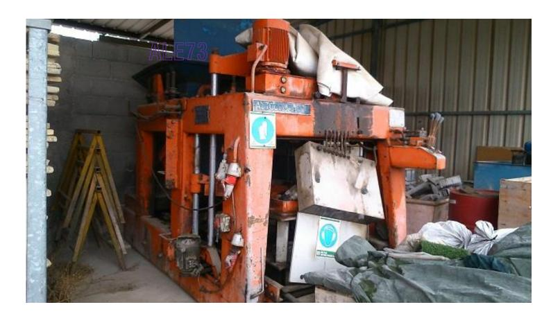
Machine '' Pondeuse '' de marque PRENSOLAND – AUTOCOMPACTA principalement pour blocs et quelques bordures. Machine un seul béton. Elle produit ses blocs en se déplaçant sur une dalle béton.
